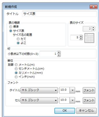
図形とリンクしない「標準」の表と、リンクする「サイズ表」を作成できます。「サイズ表」は計測値を入力することで図形とリンクします。グレーディングしているデザインは各サイズの計測値が入力されます。
