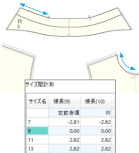
⑤ 「サイズ間計測」の「線長」で前衿ぐり長さを確認します。計測結果が正しく移動していることを確認します。
